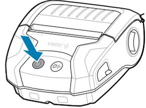
Wenn die Startsequenz abgeschlossen ist, leuchtet der **POWER**-Ring dauerhaft. Die LED-Anzeigen Fehler, Akku, WLAN, Bluetooth geben den aktuellen Status des Druckers an.
