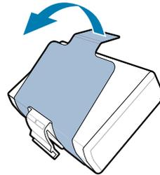
4. Ziehen Sie das Isolierband ab und entfernen Sie es von der Oberseite des Akkus. Entsorgen Sie es nach dem Entfernen.
