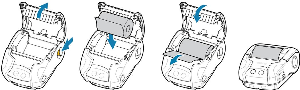
1. Schieben Sie die Entriegelungstaste nach vorne, um die Medienabdeckung zu öffnen.
