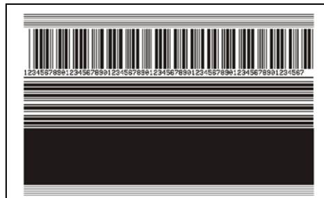
Abbildung 22 • Mit PAUSE gedrucktes Testetikett
